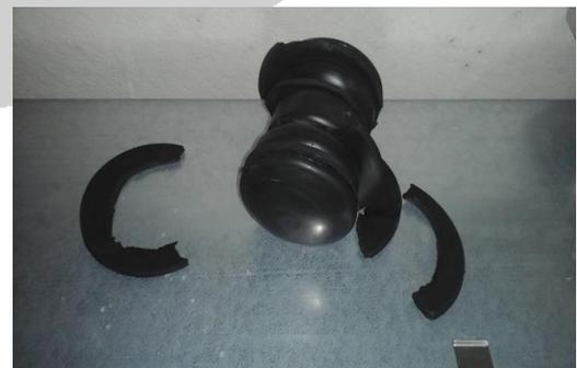
Abbildung 5: gerissene Dichtlippen durch zu hohe Geschwindigkeit [2]
