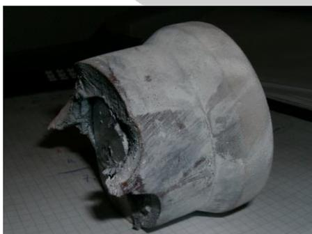
Abbildung 4: Abgescherter Molch nach Einschlag [2]
